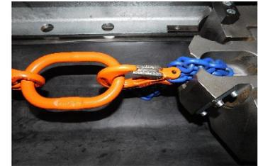
Die gesetzlich vorgeschriebenen Riss-, Maß- und Sichtprüfungen werden durch unseren Safety Trailer durchgeführt. Die Prüfung erfolgt für professionelle Anschlagmittel aus dem Hause pewag für folgende Sortimente:
